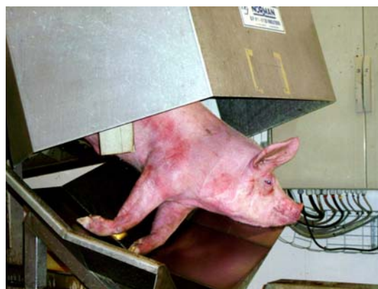
ภาพที่ 30 การทำให้สลบด้วยไฟฟ้าโดยผ่านเครื่องระบบอัตโนมัติ
